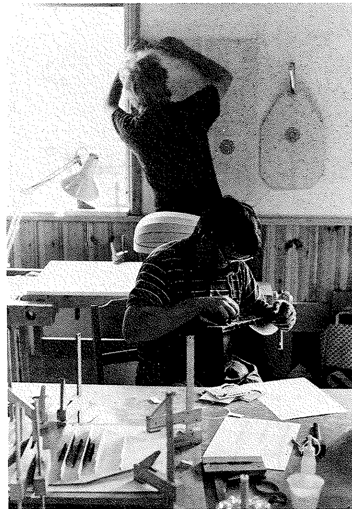
I förgrunden locket med pålimmade och avfasade balkar. Limning pågår, därav alla tvingar. Enar Magnusson besträngar och Kaj Derans mäter ut något på ritningen. Foto: Arne Lindberg.
