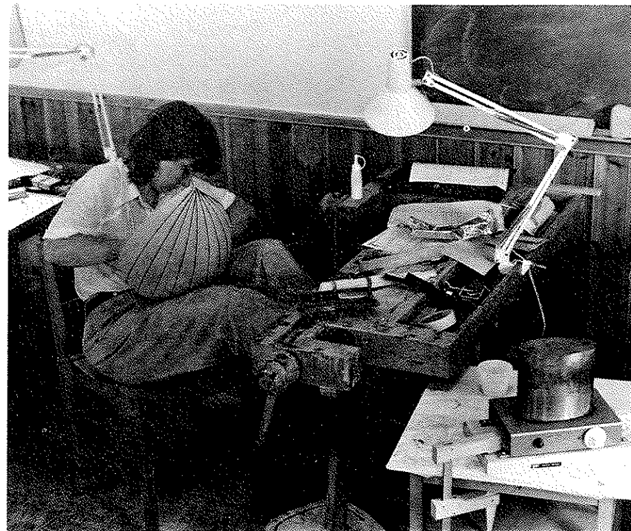
Ingrid Holmström sicklar insidan av skopan. I förgrunden syns basningsjärnet. Foto: Arne Lindberg.
