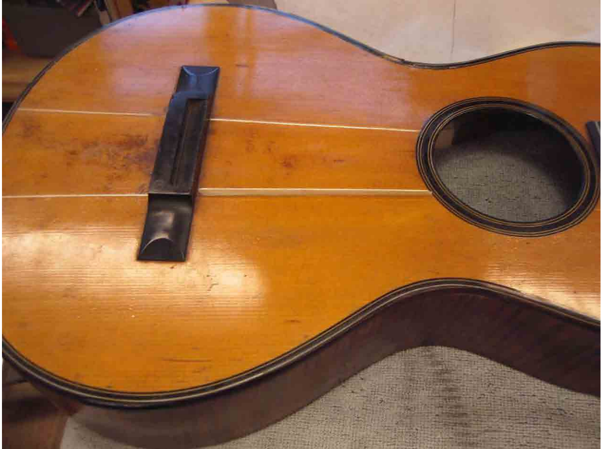
Sprickorna i locket med granstickor ilagda
