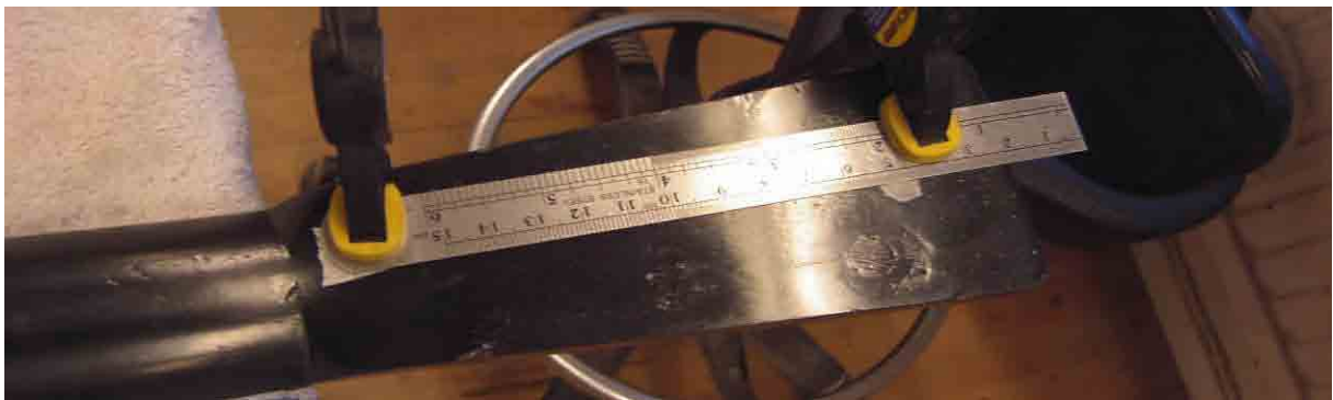
Uppmätning för att märka ut de nya stämskruvarnas placering
