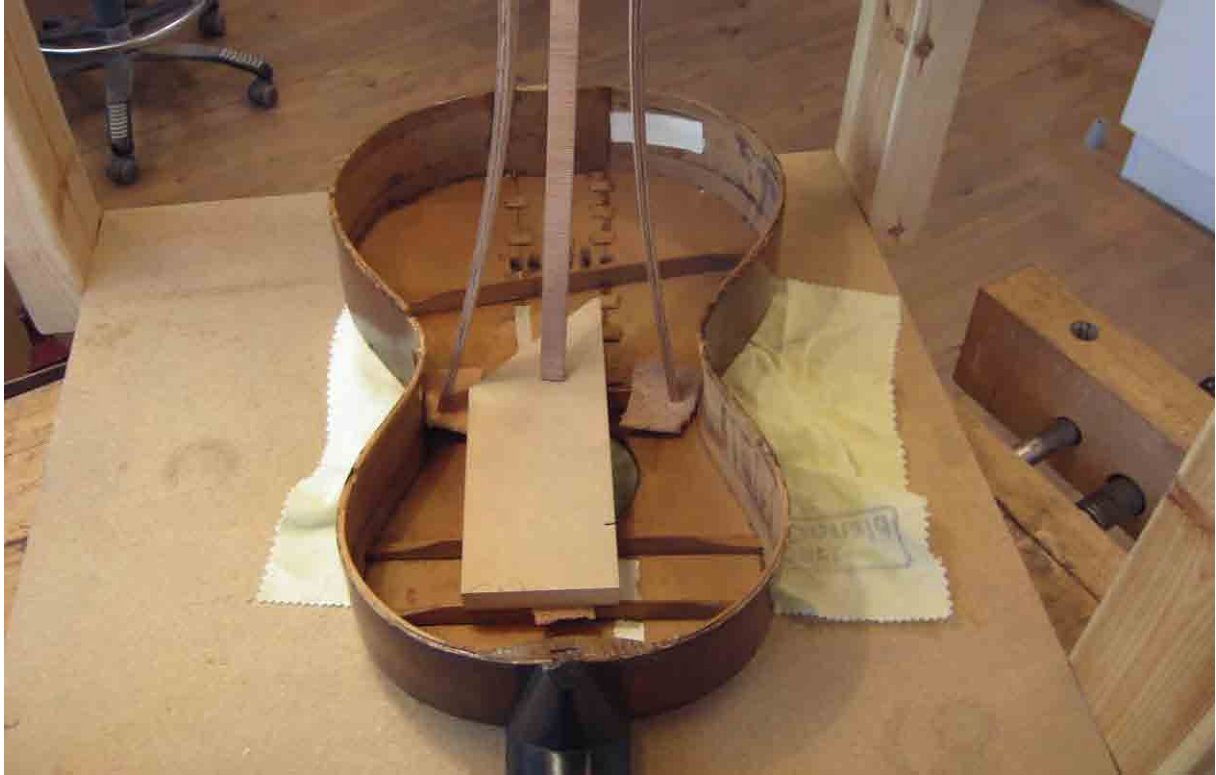
Limning av mittenbjälken
